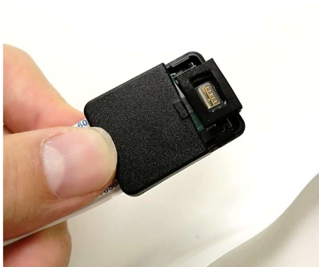
延長ケーブル先端にセンサー固定/スペーサ設置
