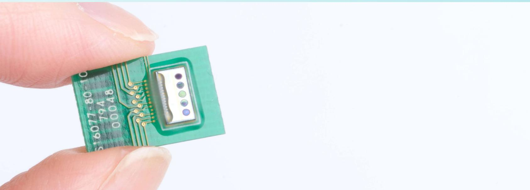
CMOS型センサー 5C-SSM
